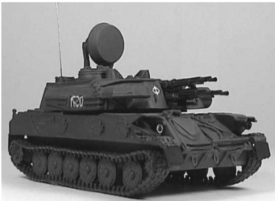
توپ ۲۳مم چهار لوله‌ای پدافند هوایی خودکششی (شیلکا)
