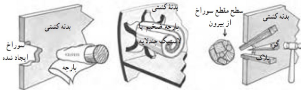
شکل ۱ - انواع گوه و نحوه مسدود کردن سوراخ به وسیله پلاک، گوه و پارچه
